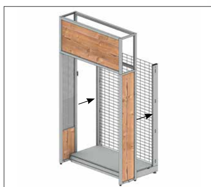
Gondelkopfüberbau mit Werberahmen montieren
