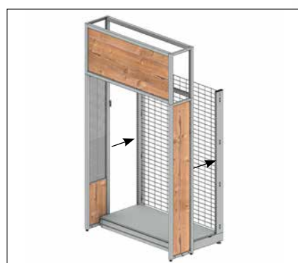
Montage de la superstructure de tête de gondole avec cadre publicitaire
