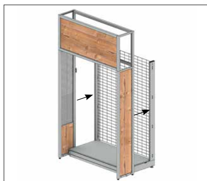
Installazione della sovrastruttura della testata a gondola con cartello pubblicitario
