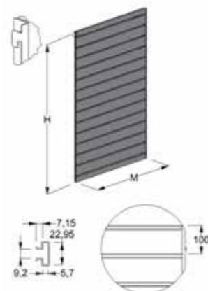
**BACK PANEL SLAT WALL****BACK PANEL - SLATT WALL**
