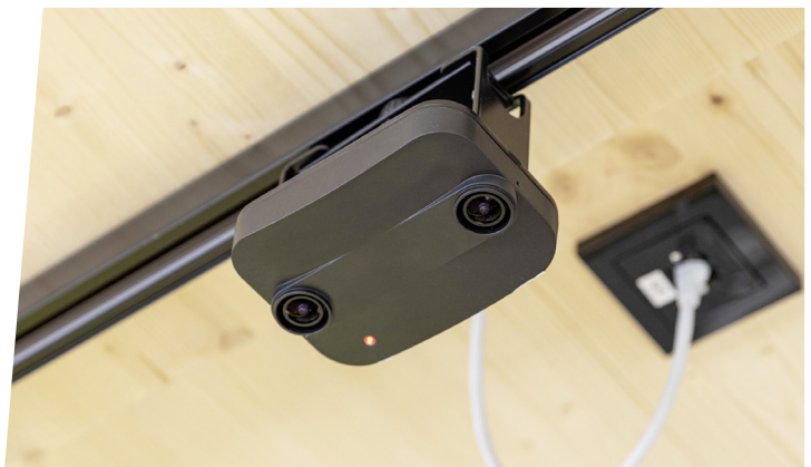
↑ PERSONENZÄHLER Neueste Sensorik im Einsatz
